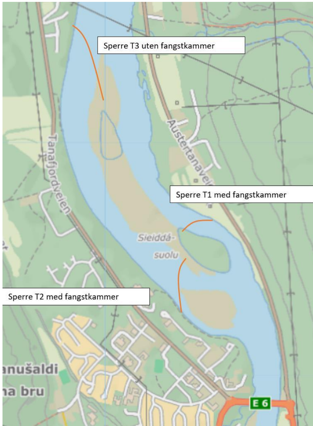
Figur 10. Aktuell sperrelokalitet ved Seidaholmen, der det er mulig med flere ulike sperreløsninger. En mulig løsning er å sperre av tre elveløp med to sperrer (T1 og T2). Et alternativ er å sperre av de to sidene av Seidaholmen med to sperrer (T1 og T3). Figuren er utarbeidet av Sweco.
