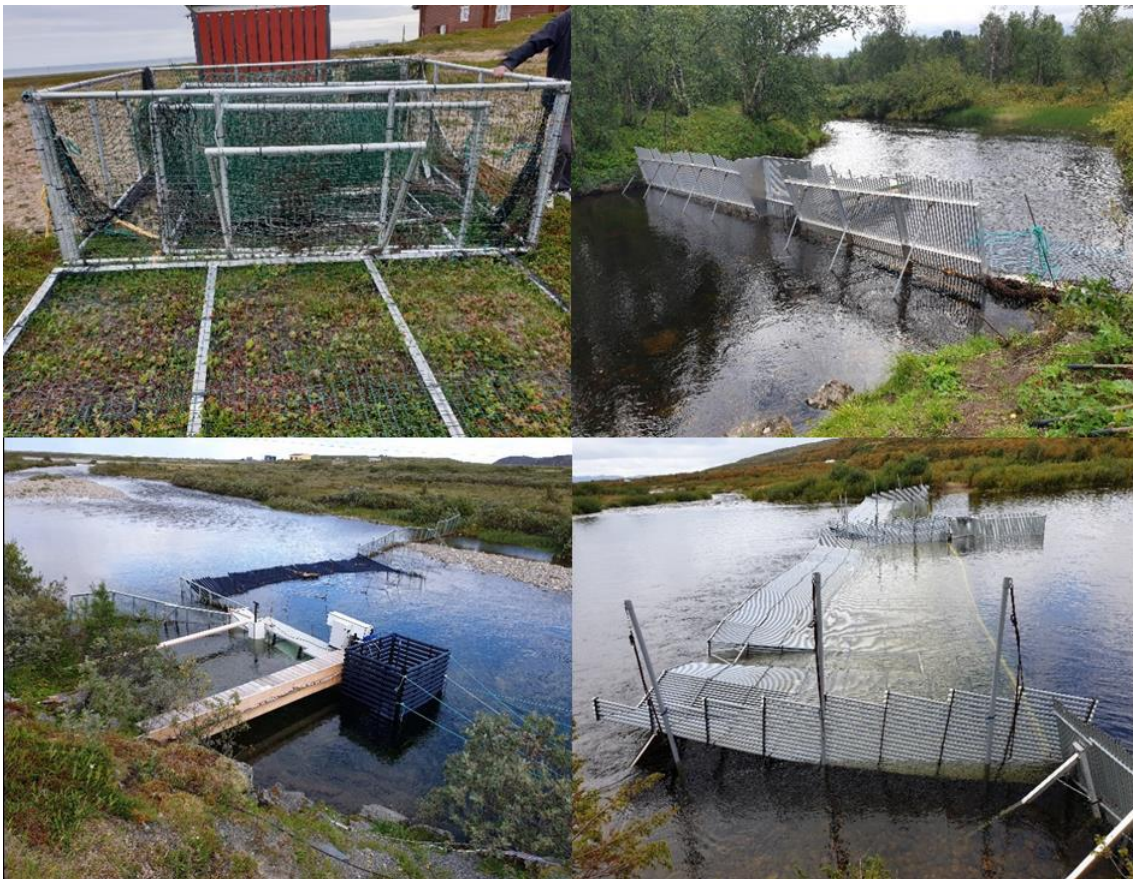
Bildeserie 1. I Finnmark er det benyttet ulike felleløsninger for å fange pukkellaks. I Komagelva (øvre venstre bilde) er det benyttet ledegjerder og fangstkaske bygd av netting, i Karpelva (øvre høyre bilde) er det benyttet en ristfelle med aluminiumsrør, i Storelva i Kongsfjord (nedre venstre bilde) er det benyttet en kombinasjon av flytende rør og vertikale rister, og i Vestre Jakobselva (nedre høyre bilde) er det benyttet en USA-produsert flyteristfelle. Alle foto: Gunnbjørn Bremset, NINA.
