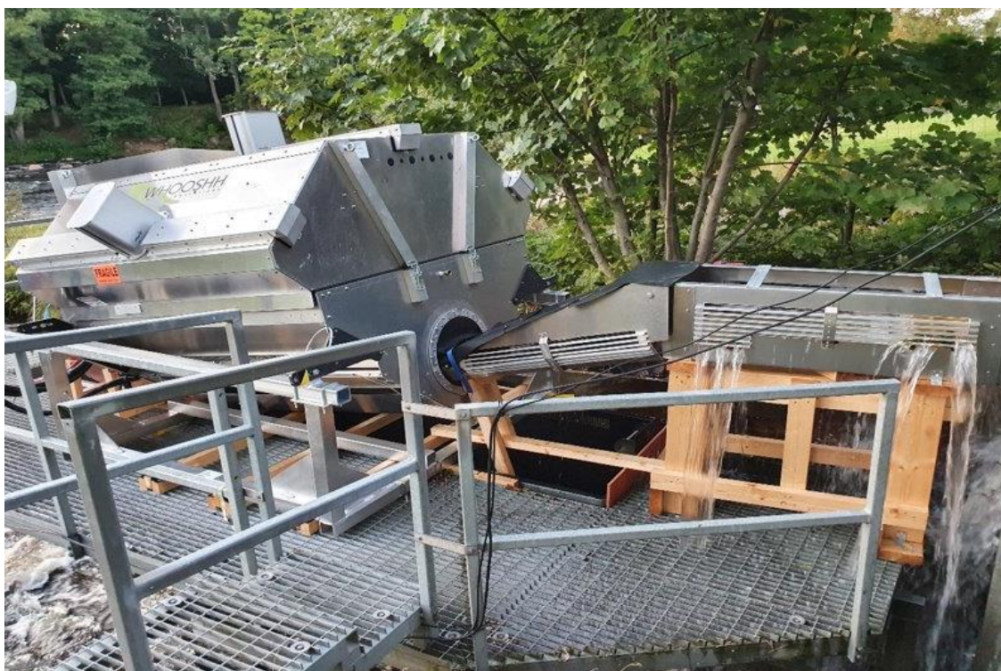
Bilde 2. Whooshh Innovations i USA har utviklet flere tekniske løsninger for automatisk identifisering og sortering av fisk. Illustrasjonsbildet er fra et system som har vært benyttet i Åtran i Sverige. Foto: Michael Messina, Whooshh Innovations.
